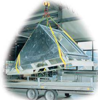
使用2條吊帶懸吊非對稱荷載，傾斜角小於45度，荷載能力系數LA=1.4
