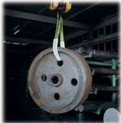
U形捲繞吊起，最大傾斜角45度(LA=1.4)
