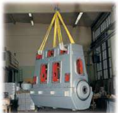
使用4條吊帶懸吊，傾斜角大於45度：荷載能力系數LA=1.5
