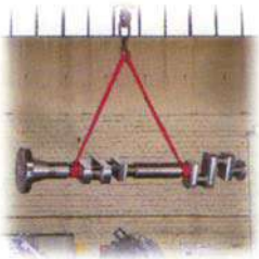
使用一雙(兩條)起重圓帶，最大傾斜角45度，吊掛方式為“單圈纏繞吊起”：荷載能力系數LA=1.12。
